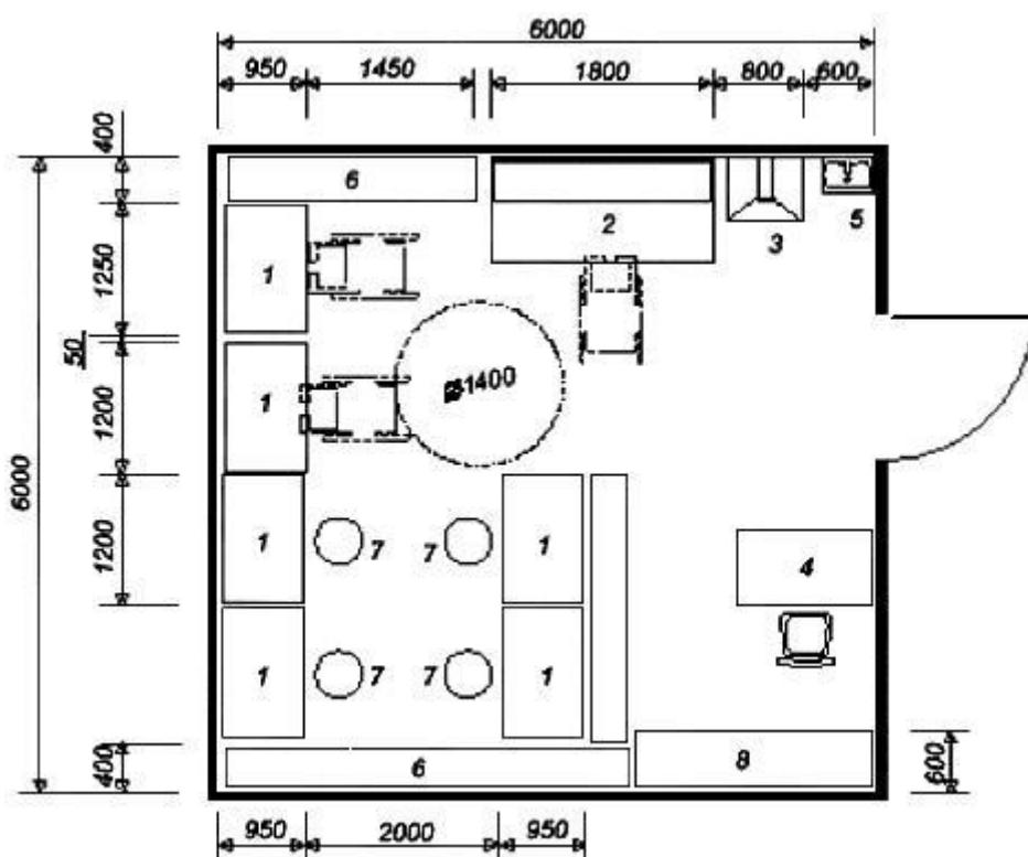
1 - стол монтажный; 2 - стенд испытательный; 3 - стол с вытяжкой; 4 - стол приемщика; 5 - мойка; 6 - стеллаж для материалов; 7 - табурет с регулируемым сиденьем; 8 - стеллаж приемщика.
