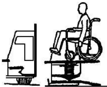
Передвижение в объекты, расположенные в подземном уровне здания, с помощью наклонного подъемника, устроенного рядом с эскалатором
