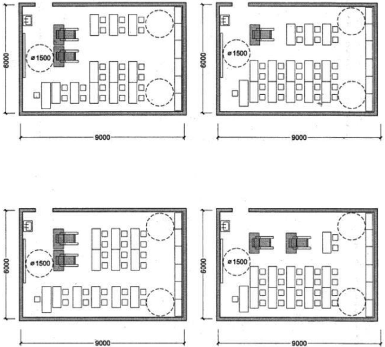
Рисунок Б.2 - Варианты планировочных решений классных помещений площадью около 50 м
