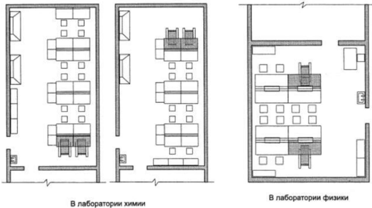
*Рисунок Б.4 - Примеры расстановки оборудования в аудитории и лабораториях химии и физики*
