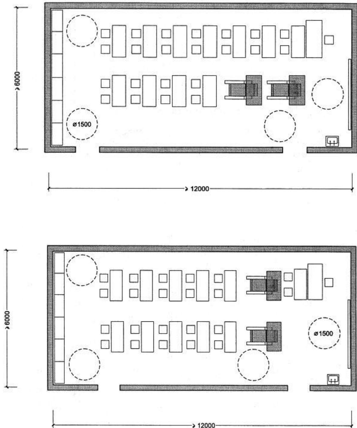
Рисунок Б.3 - Варианты планировочных решений классных помещений площадью 60-70 м
