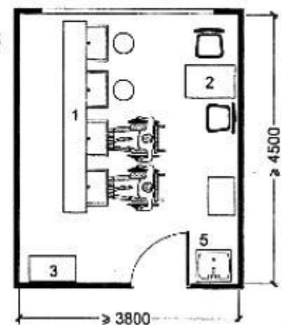
Рисунок Б.9 - Примеры расстановки оборудования в помещениях поликлиник и амбулаторий
