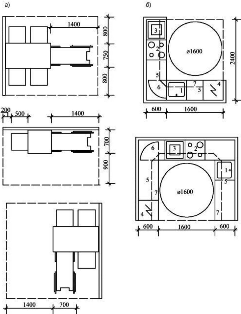
1 - мойка консольного типа; 2 - электроплита консольного типа; 3 - жарочный шкаф настольный; 4 - холодильник; 5 - полки навесные; 6 - полки поворотные; 7 - стол консольный
