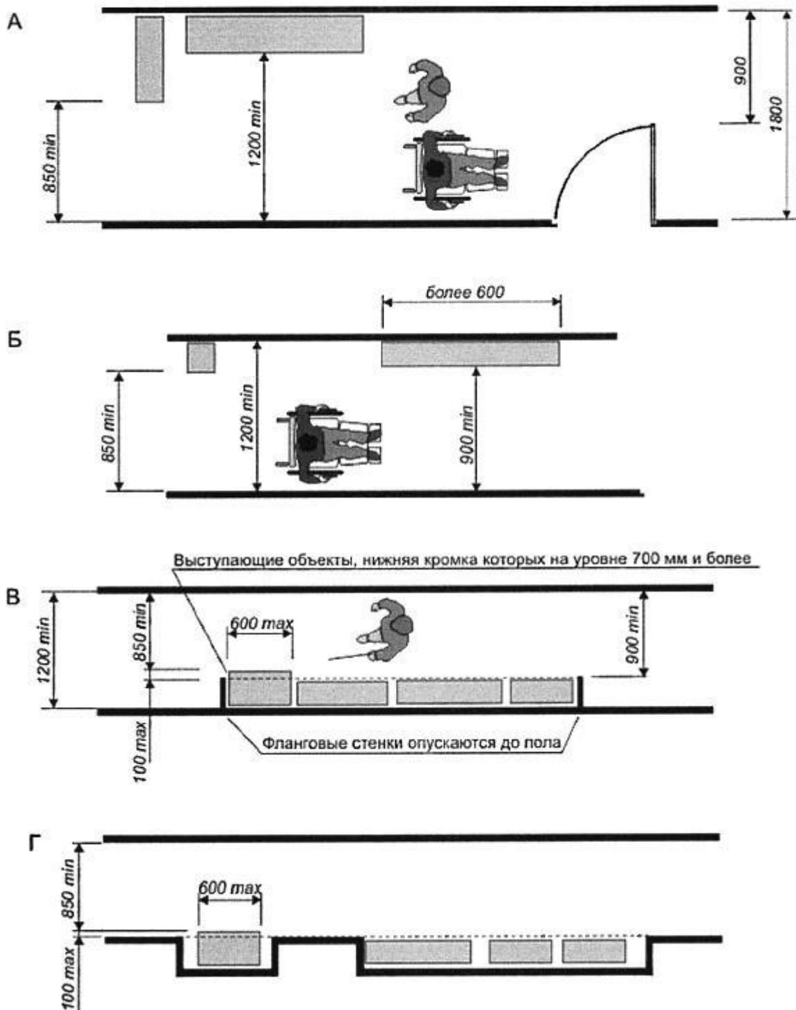
А, Б - сохранение пропускной способности коридоров; В - безопасное размещение
