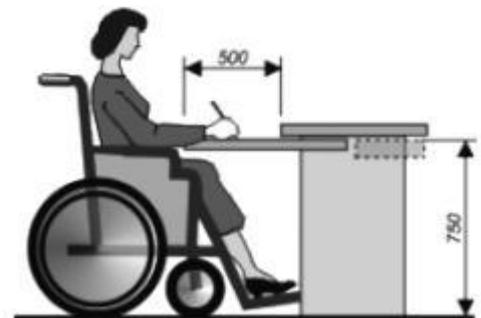
***Рисунок Г.2 - Параметры досягаемости в месте получения услуги***
