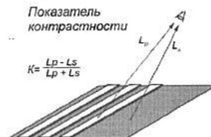
$L_s$  - яркость горизонтальной поверхности (кандела/м<sup>2</sup>)
