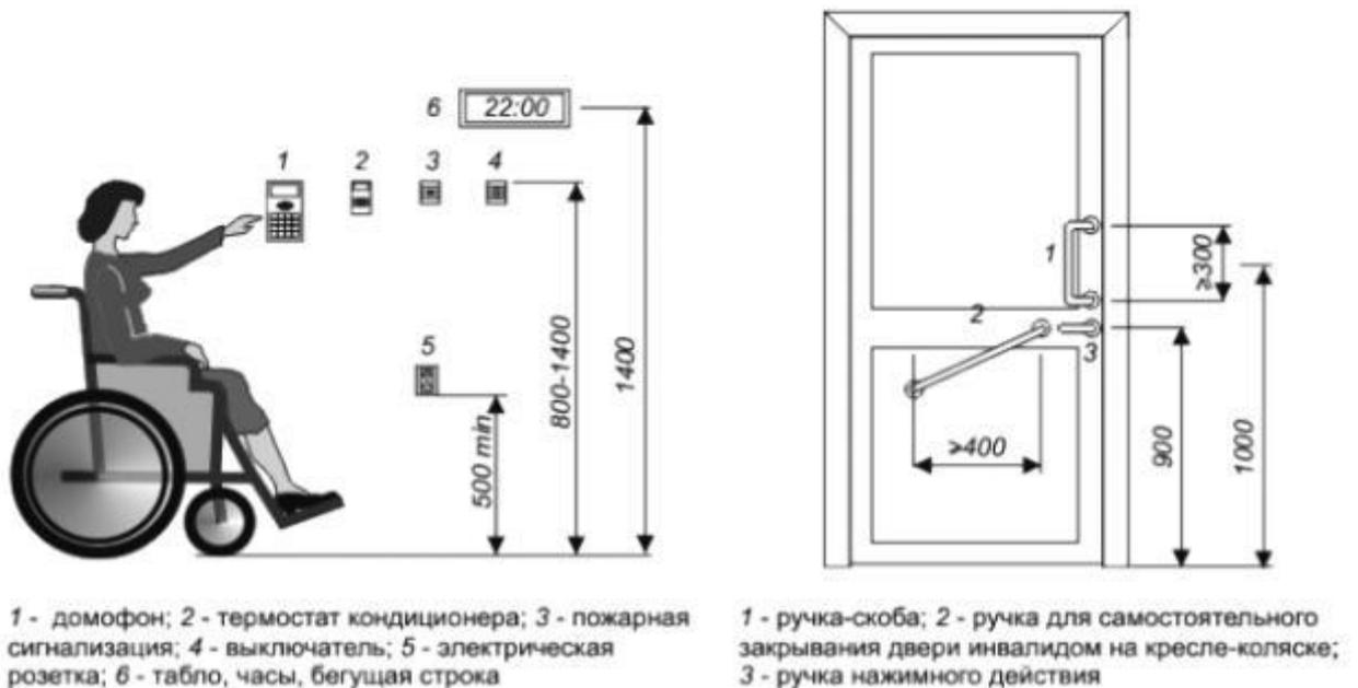
Рисунок Г.6 - Достижимость оборудования
