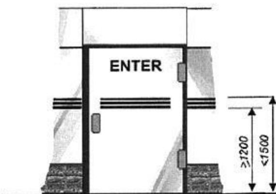
*Варианты маркировки дверей и дверных проемов*
