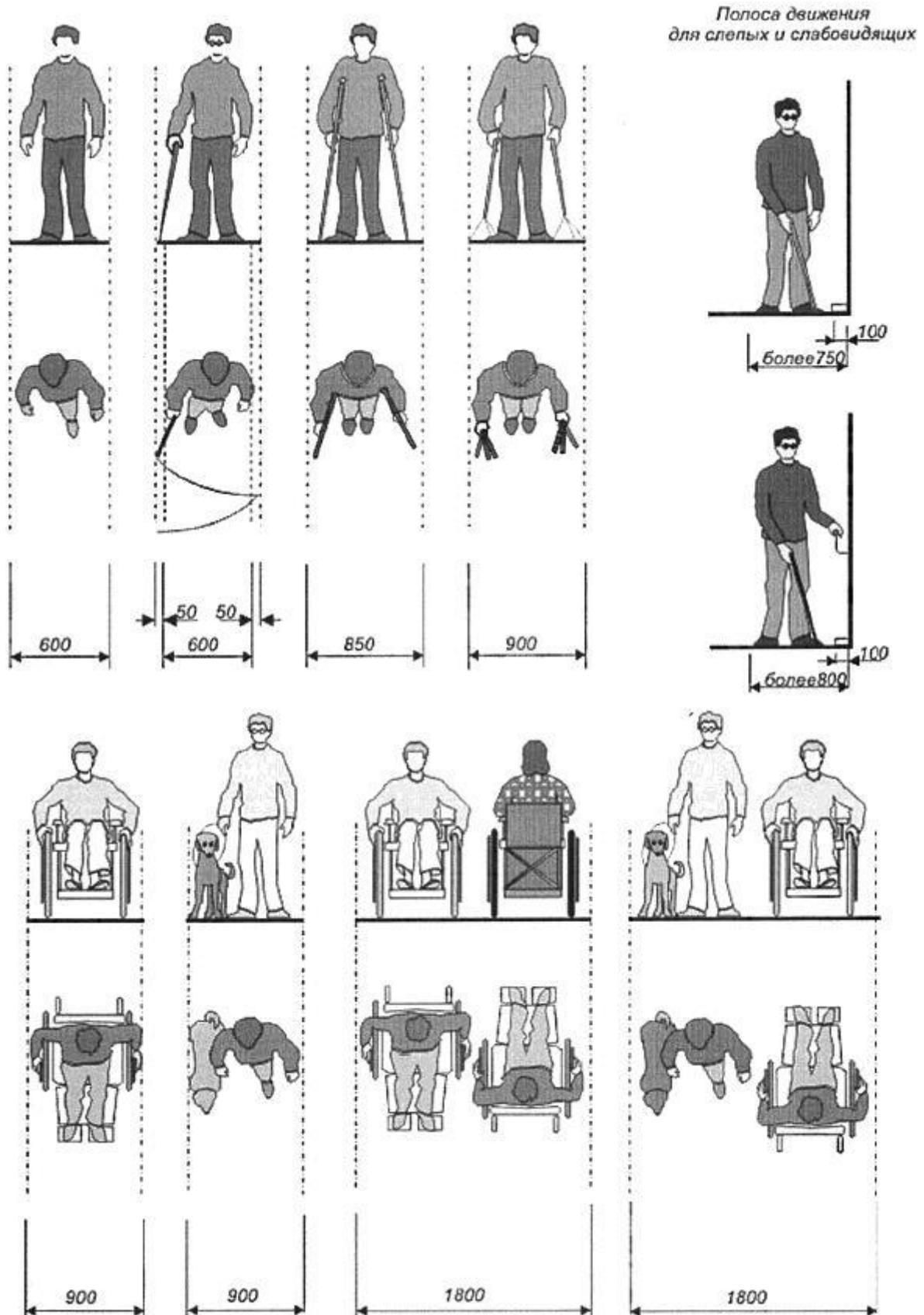
*Рисунок В.11 - Габариты полосы движения*
