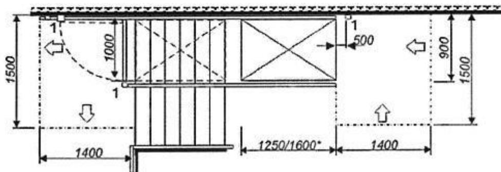
Рисунок В.31 - Параметры наклонных подъемников
