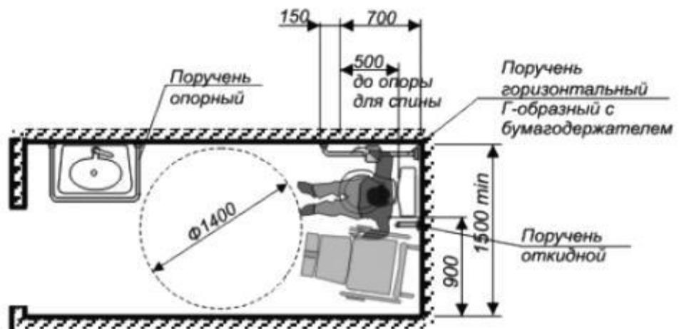
Рисунок Г.12 - Примеры оборудования совмещенного санитарного узла
