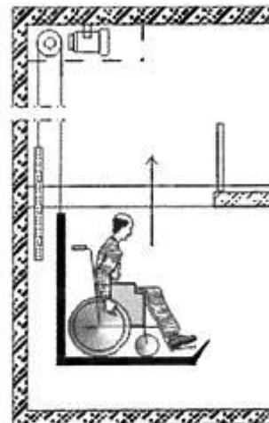
Шахтный подъемник с закрытой платформой
